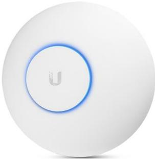
*Ein Access-Point (englisch: Zugangspunkt) verbindet verschiedene (End-)Geräte, z.B. Notebooks, Tablets oder Handys über WLAN mit einem kabelgebundenen Netzwerk (LAN).*
